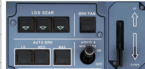
Airbus A320 Autobrake Panel
